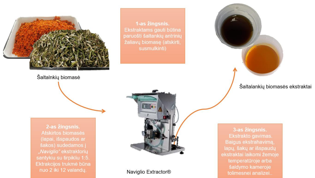
1 pav. Šaltalankių antrinių žaliavų biokoncentratų gavimo principinė schema.
